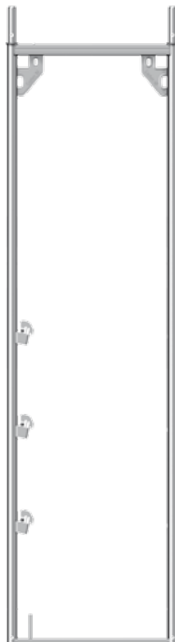
EURO STELRAAM 2.80 X 0.73M STAAL (26.7KG), VOLBAD VERZINKT OF ALUMINIUM (10.7KG),
